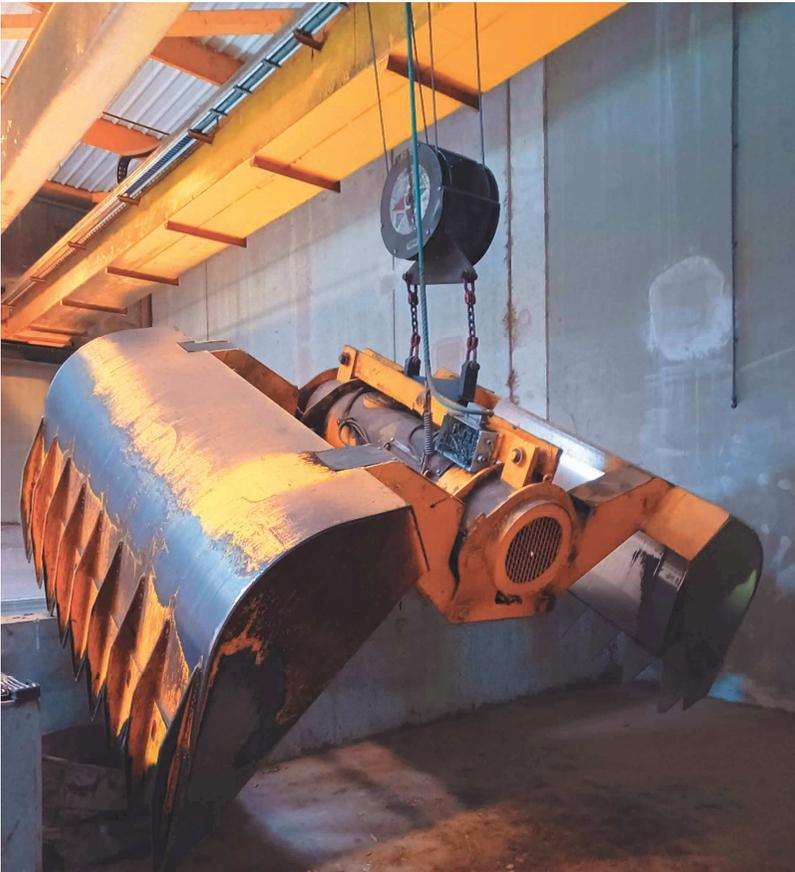
*Essai de l'inclinomètre et des déclenchements automate*
