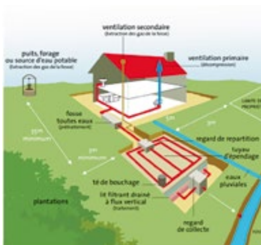
Principe de l'assainissement non collectif
